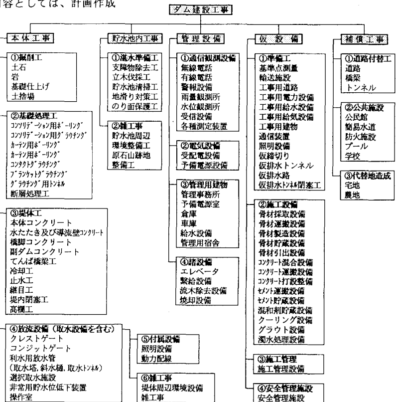
図2 ダム工事の工程とその内容
