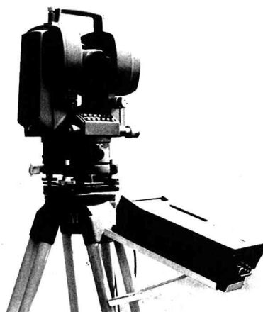
写真 1 エレクトロタキオメータ、三脚についているのがデータ記録装置
