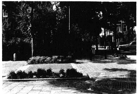
写真-2 盛上げ舗装とレーン狭みの例 (Rijswijk市)
