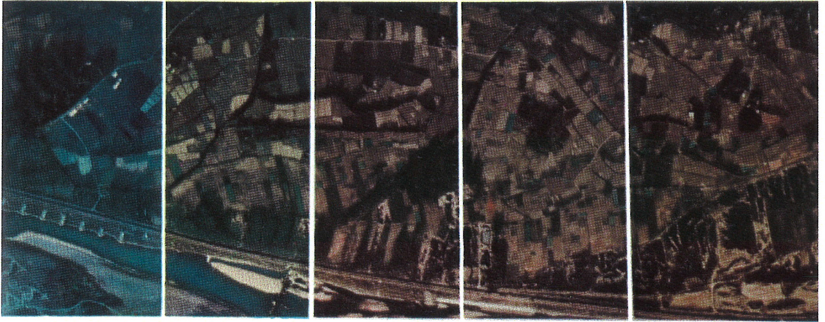
原板の黄色層を減力して作ったプリント。 減力の時間によって色調がこのように変化する。
