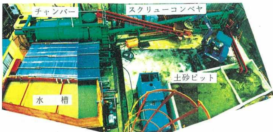
写真-1 実験装置全景
