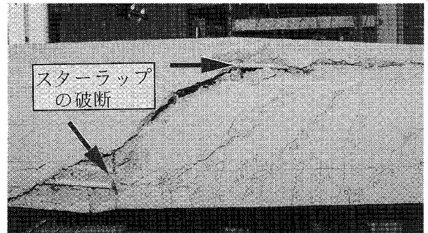
写真-1 破壊時のひび割れ状況 (No.9)
