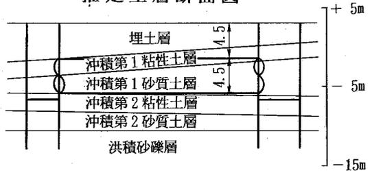
図-22 実証実験平面および土質縦断面図
