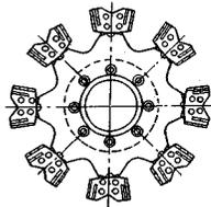
図-8 遊星カッタービットの形状
