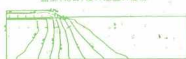
盛土(40日)後の地下水の流れと水頭 コンターおよび自由水面
