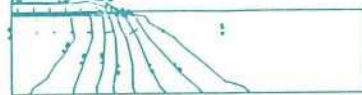
盛土(40日)後の地下水の流れと水頭 コンターおよび自由水面
