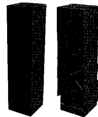
柱の崩壊 (3DEC使用)
