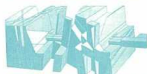
亀裂性岩盤の3次元掘削解析
