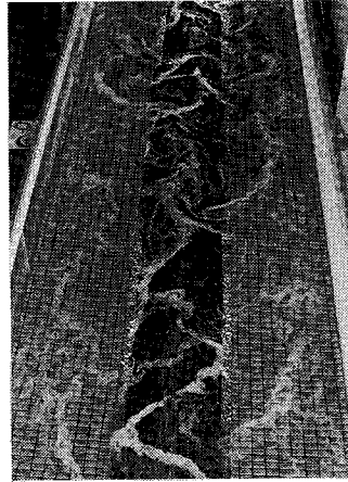
写真-3 流況可視化写真 (CASE-B 断続配置)
