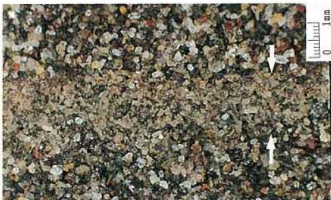
写真六 主働域のせん断層の顕微鏡拡大写真 (写真二の上の丸印)
