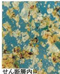
写真七 主働域のせん断層内外の粒子の顕微鏡拡大写真 (写真二の下の丸印)
