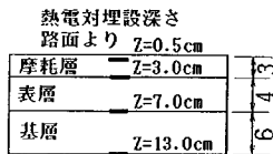
図-6 温度測定用舗装体の断面
