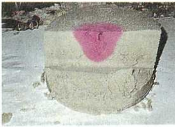
写真一三 砂質土の割裂状況
