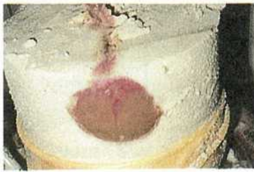
写真一四 砂質土の割裂状況
