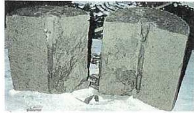
写真-2 固結砂の割裂状況
