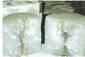
写真—11 パラフィンの割裂状況
