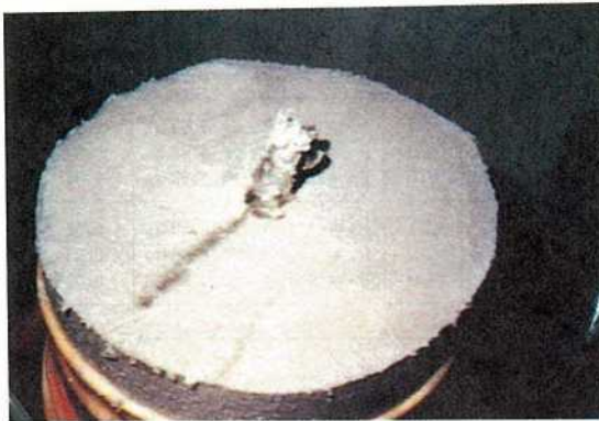
写真二 割裂後のグラウトの注入状況 (試料 S3, グラウト B)
