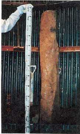
写真-5 A2の加圧状況 (割裂発生せず, グラウトA')
