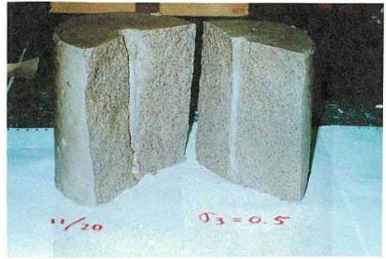
写真-3 割裂後のグラウトの注入状況 (試料 C2, 水注入)
