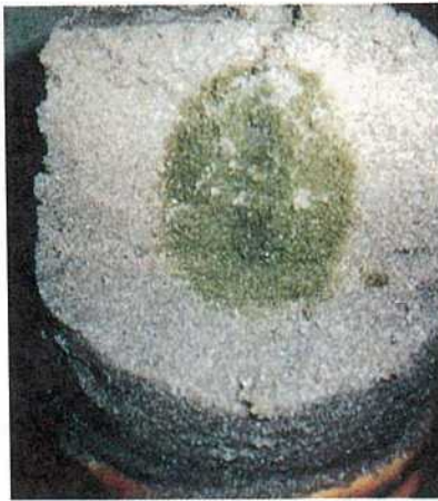
写真一 割裂後のグラウトの注入状況 (試料 S1, グラウト B)
