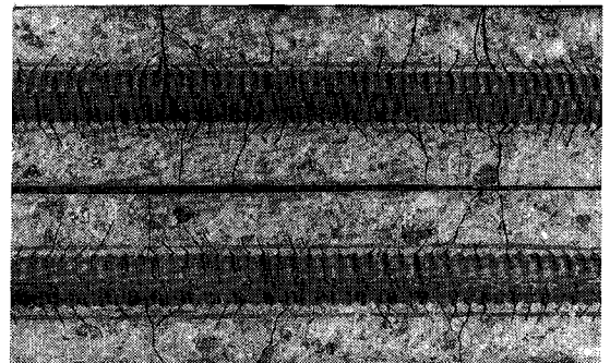
写真—2 インク注入法により得られた内部ひびわれ発生状況 (鉄筋：D51，鉄筋応力度：3 000 kgf/cm 2 (294 MPa)， 骨材最大寸法：25 mm)
