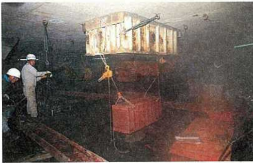
写真-1 ケースⅡの載荷装置組立て
