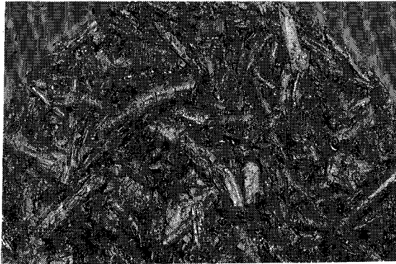
写真-2 泥炭試料に混在していた腐植木片
