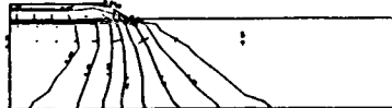
盛土(40日)後の地下水の流れと水頭 カウンターおよび自由水面
