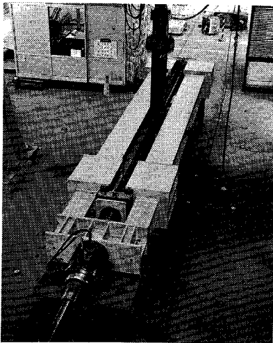
写真-1 曲げ疲労実験状況
