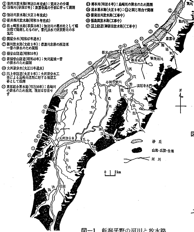
図-1 新潟平野の河川と放水路
