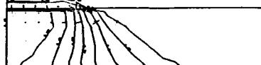
盛土(40日)後の地下水の流れと水頭コンターおよび自由水面
