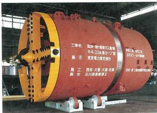
写真-1 東電-石播タイプ急カーブ掘進型シールド機械
