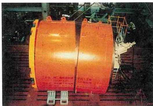
写真-3 東電-川重タイプ急カーブ掘進型シールド機械
