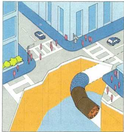
図-1 交差点直下での急カーブ施工
