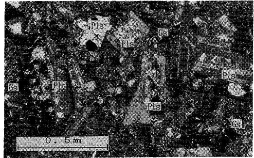
写真-3 斑晶斜長石結晶の全体を置換したス멕タイト(直交ニコル) (Pls:斜長石(ス멕タイトで交代), Gs:ス멕タイト化した石基)
