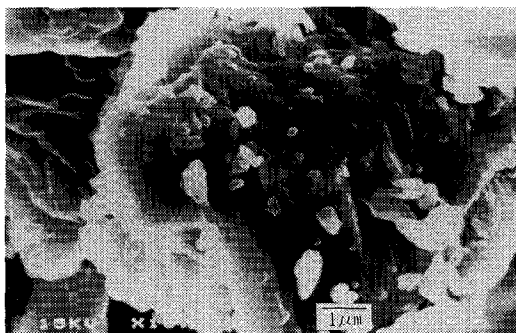
写真-14 電子顕微鏡で観察された斜長石結晶の中に生成した微小塊状のスメクタイトの結晶形態
