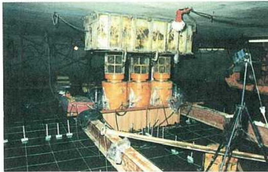
写真-1 載荷試験装置 (CASE III)
