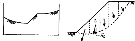
(b) 遠心加速度場を考慮した斜面の模型 (c) 遠心加速度場を考慮した解析モデル
