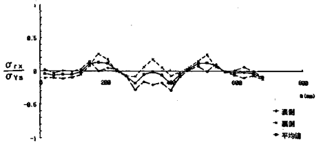
図-9 閉断面補剛材 (SS41) 単体での \sigma_{xx} の s 軸方向分布
