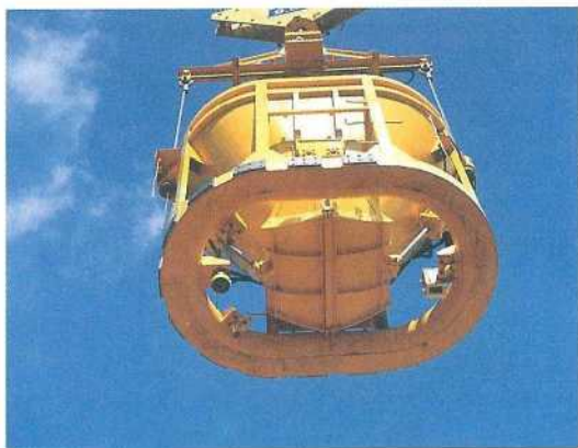
写真-5 コンクリートバケット
