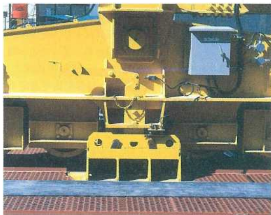
写真-2 浮き上がり逸走防止装置
