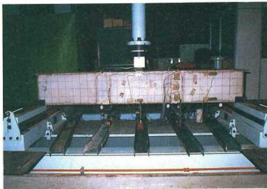
写真-5 継手部載荷試験
