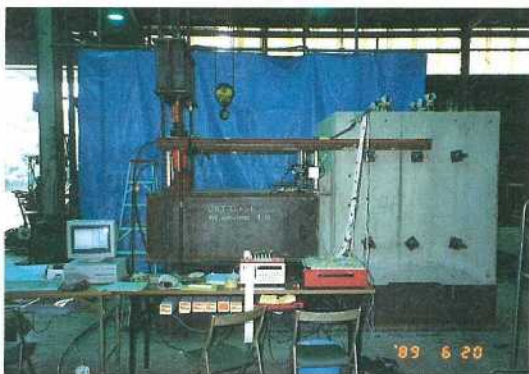
写真一六 定着アンカーによる結合部載荷試験
