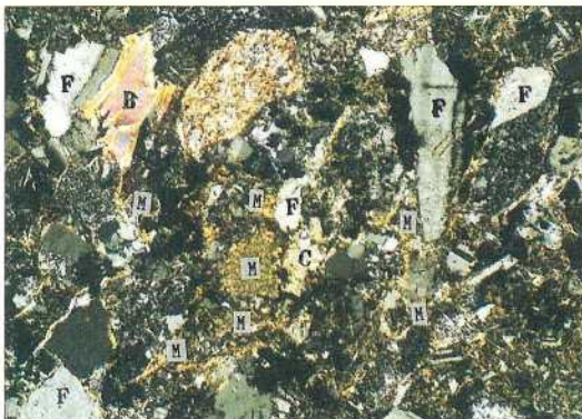
F: 正長石, B: 黒雲母 C: 緑泥石, M: モンモリロナイト
