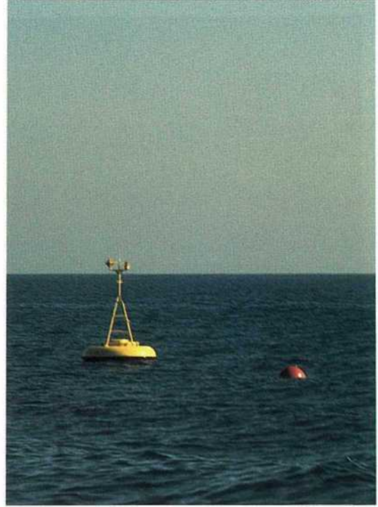
巻頭写真-3 ウェーブライダー型波浪計（波面の上下加速度を計測して水面変位を求める）
