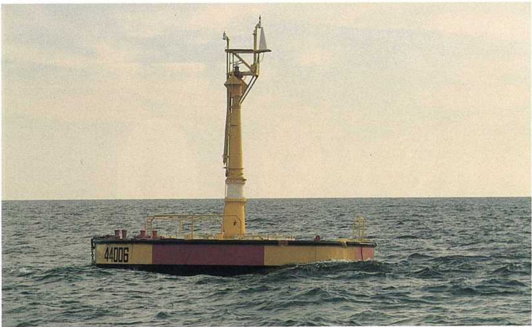
巻頭写真-4 ノースカロライナ沖約 40 km に設置された NOAA (National Oceanic and Atmospheric Administration) の大型ブイ（直径約 10 m、一般の気象・海象の観測に加えて、ブイの運動自体を計測して海洋波浪の方向スペクトルも求めることができる）
