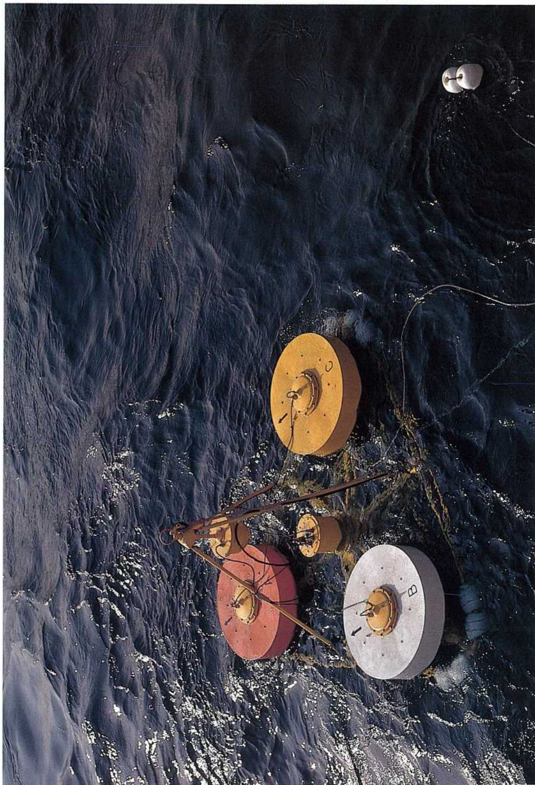
巻頭写真一 九州大学応用力学研究所が開発したクローバー型波浪計（波面の上下加速度，傾斜および曲率を計測し，海上波浪の方向スペクトルを高精度で求めることができる）
