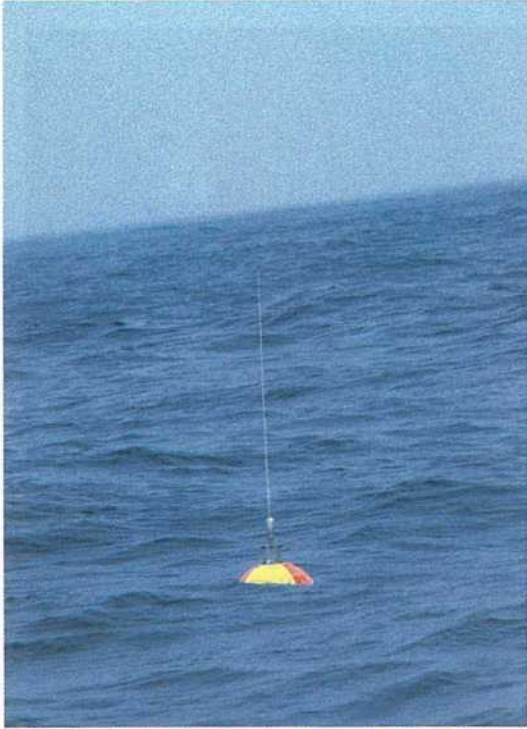
巻頭写真-2 カナダの内水域研究センターのピッチロール型波浪計（波面の上下加速度および傾斜を計測して、海洋波浪の方向スペクトルを求める。このブイは風向、風速等の気象に関する観測も同時に行う）
