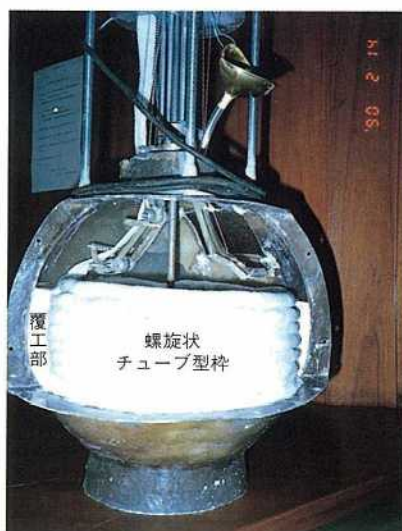
写真—4 チューブ型枠のモデル (左は第1層のチューブをらせん状に敷設するところ、右は中段までコンクリート覆工を済ませたところ) (1989)
