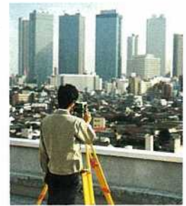
写真-11 光波測距儀による屋上間の距離測定
