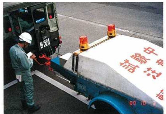
写真—2 ダイナフレクトによる舗装の破損調査
