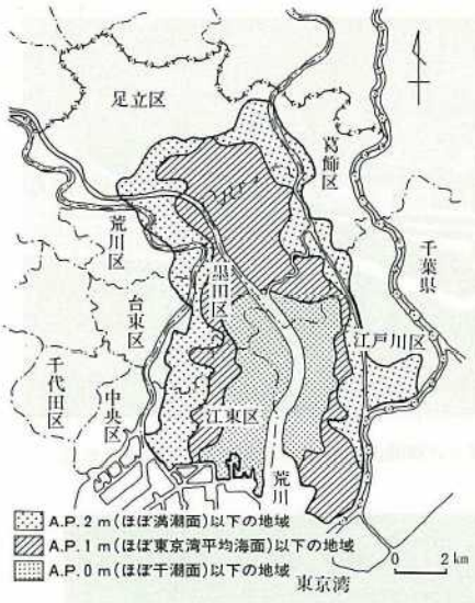
図-1 水準測量によって明らかにされたゼロメートル地帯の現況
