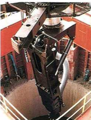
当研究所が主となって新規開発し、土木学会の技術開発賞を受賞した軟岩用のアーム式水中掘削機
