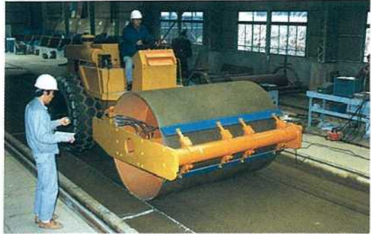
第二試験棟内のソイルビンとローラの締固め性能試験
