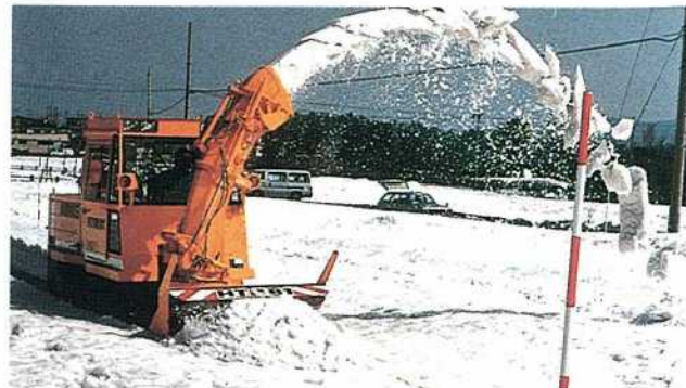
積雪期に、北海道・東北・北陸などの現場に向いて行う除雪機械の性能試験
