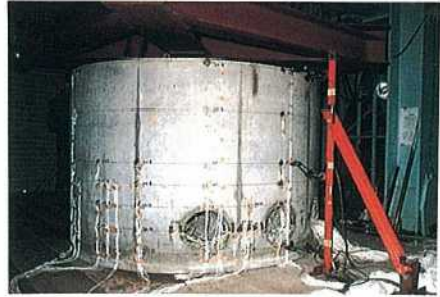
大規模立坑のシールド発進孔付近の応力を検討するための1/50供試体による実験解析
