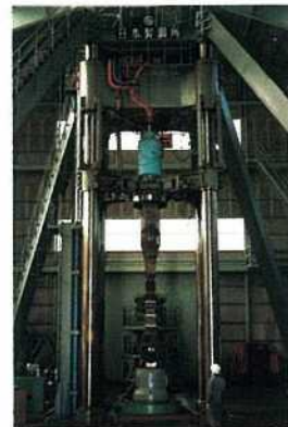
本州四国連絡橋公団400トン疲労試験設備と高張力鋼の溶接継手の疲労試験
