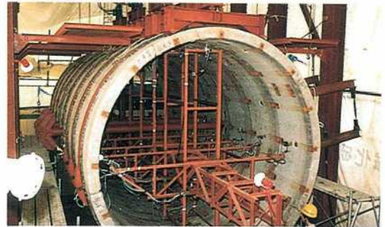
枝管接合時の挙動を確認するために，実物のシールドセグメント（ \phi 3.2\text{ m} ）を使用した載荷試験
