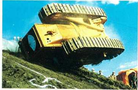
傾斜地試験場(30度)を利用して行う建設機械の転倒、転落実験
