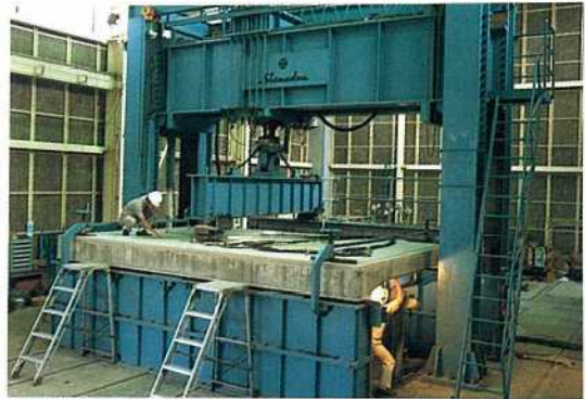
日本道路公団100トン疲労試験設備とRC床版の疲労試験
