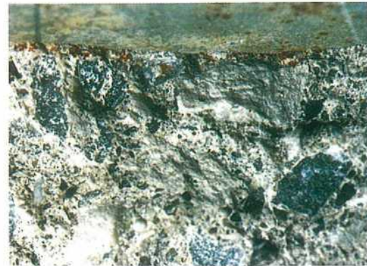
写真-5 鉄粉混入コンクリート供試体断面における鉄粉の腐食状態
