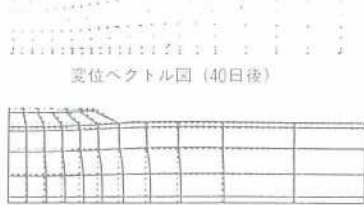
盛土(40日)後の地盤の変形
