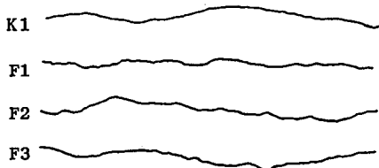
図-10 自然岩盤表面の亀裂形状
