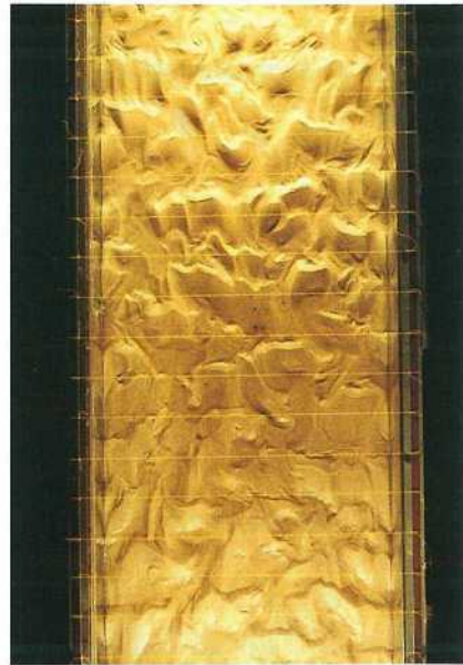
写真—2 前写真河床波の俯瞰写真 (糸間隔 10 cm, 流向：画面下から上)
