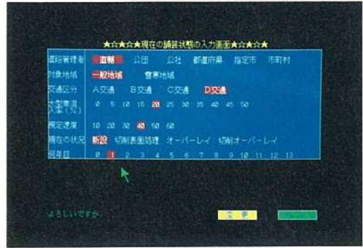
図-6 舗装状態診断部の入力画面
