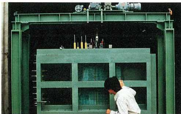
鉄筋補強土工法載荷試験
