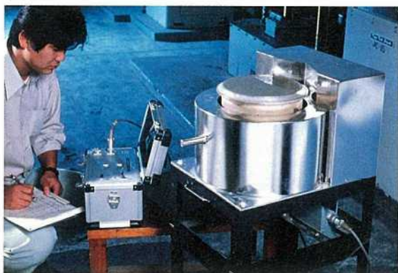
コンクリート水量測定器（RI水分計）
