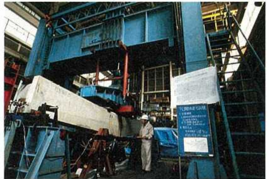
PC 桁疲労試験
