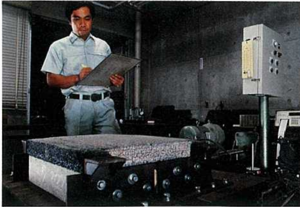
埋設型伸縮装置の試験
