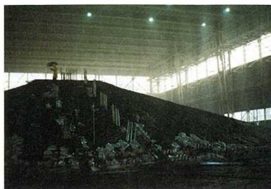
大型降雨実験施設を利用した丘陵斜面の崩壊実験
