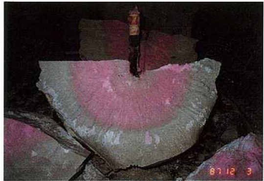
試料E(ケイ砂7号) q=10 (L/分), t=5 (分)
