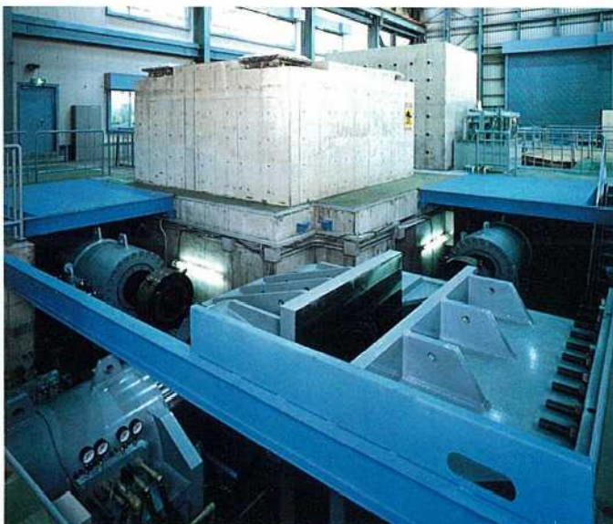
写真—2 高速増殖炉用免震要素の性能評価実験装置
