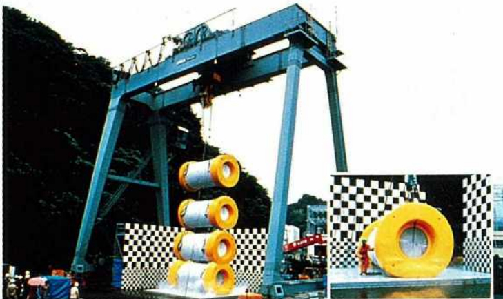
写真-4 100トン級使用済み燃料輸送容器落下実験
