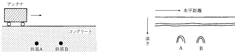
図-29 レーダーによるコンクリート断面の探査
