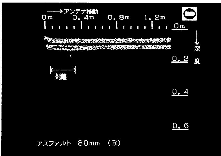
図-32 床版の空隙調査レーダー画像（レーダー反射波の強い赤色部が剥離している）
