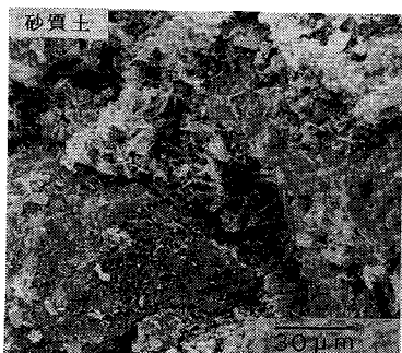
写真-9 砂質土・石灰処理土(添加量: 10%, 90日材令)のSEM像
