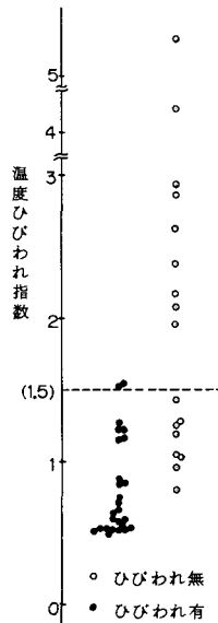
図-8 応力解析から求めた温度ひびわれ指数の分布
