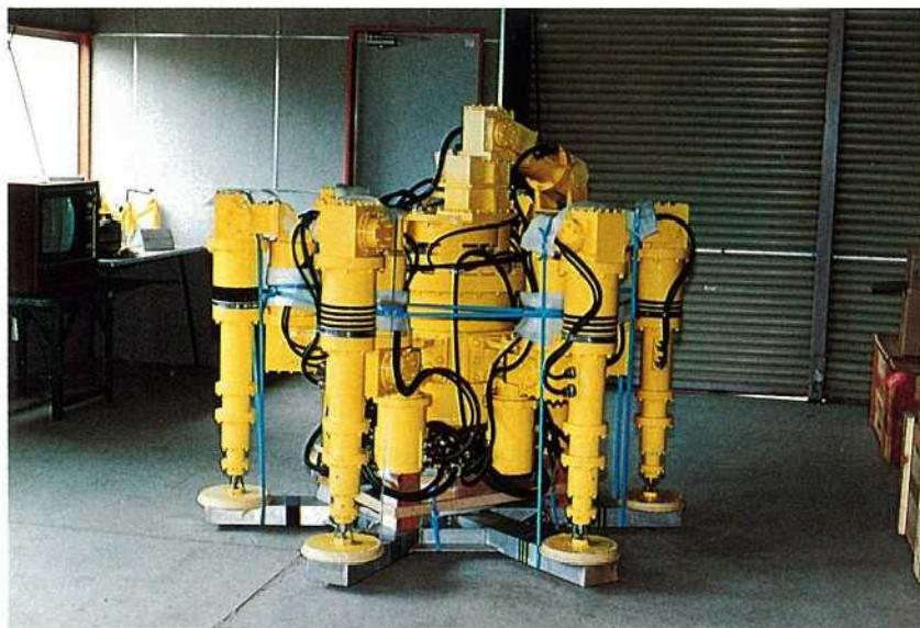
歩行式水中調査ロボット実験機（防水型） 写真提供：運輸省港湾技術研究所
