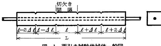
図-1 両引き試験供試体一般図
