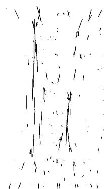
図-5 一軸圧縮接触力分布
